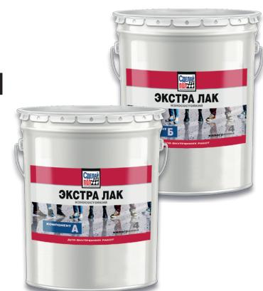
Компонент А и компонент Б предварительно размешивают, затем – в компонент А постепенно добавляют компонент Б. Полученную смесь тщательно перемешивают дрелью (не более 400-600 об./мин.) в течение 1 - 2 минут, избегая замешивания воздуха. Дают отстояться в течение 10 мин. для выхода вовлеченного воздуха. Использовать приготовленный состав в течение 3 часов.
